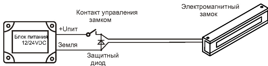
Рисунок 8 – Схема подключения замка
