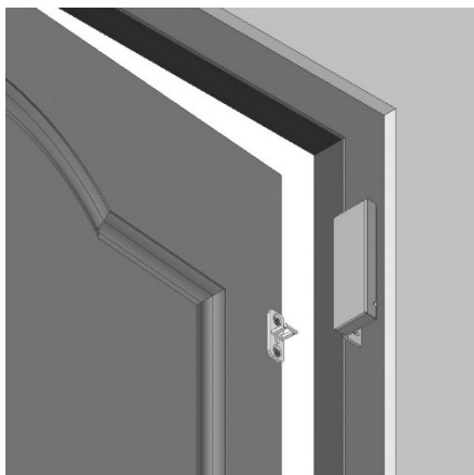
Рисунок 3- Установка замка на монтажный L-уголок
