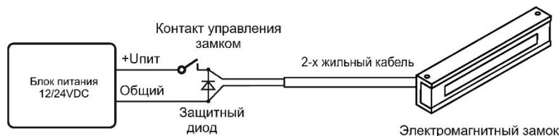
Рисунок 8 – Схема подключения замка
